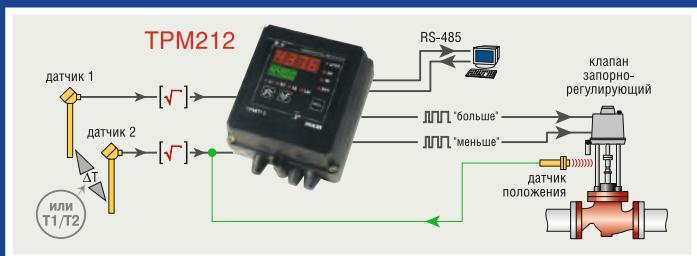
ПИД-регулятор для задвижек и трехходовых клапанов **TPM212** поддерживает температуру в системах ГВС, газового и парового отопления, водяного охлаждения и др.
