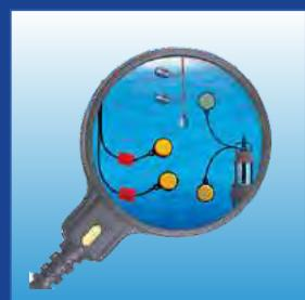
В основу принципа действия таких датчиков заложено свойство жидкостей выталкивать погруженные в неё предметы. Изменение уровня жидкости приводит к соответствующим изменениям угла наклона поплавка, что смещает расположенный внутри поплавка шарик, который нажимает на концевик.
