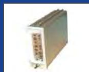
Приборы Ф34 предназначены для применения в схемах контроля пламени горелочных устройств и топочных камерах стационарных котлов и печей. Исполнения: Ф34.2 – контроль пламенем и управление розжигом; Ф34.3 – контроль пламени.
