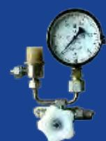
Редуктор давления является вспомогательным устройством для газоаналитических систем, а также отдельных газоанализаторов. Предназначен для снижения давления анализируемых газовых смесей, контроля по манометру и предотвращения повышения давления с помощью предохранительного клапана. Редуктор давления имеет следующие исполнения: РД-10К, РД-10Т, РД-10КТ.
