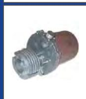
Фотосигнализатор пламени ФСП используется в топливосжигающих установках котлов и печей для контроля и сигнализации о пламени и управлении розжигом, работает как автономное устройство. Преобразовывает низкочастотные пульсации видимого и инфракрасного излучений пламени в топочных камерах в дискретный двухпозиционный выходной сигнал.
