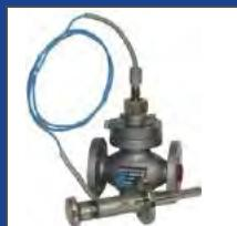
Регулятор температуры прямого действия типа РТС-ДО(ДЗ) пилотный предназначен для автоматического поддержания температуры регулируемой среды путём изменения расхода пара, жидких и газообразных сред, неагрессивных к материалам регулятора.
