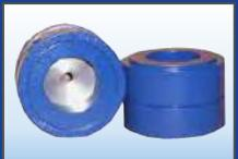
Диафрагмы предназначены для измерения расхода жидкостей, газов, пара по методу переменного перепада давления с использованием стандартных сужающих устройств. Используются в комплекте с преобразователями разности давления или дифманометрами.
