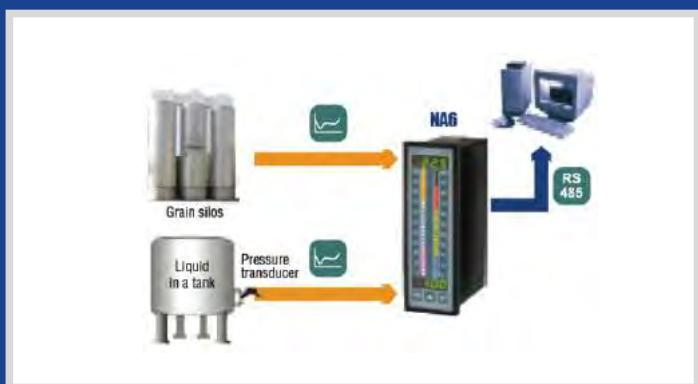
Измерение уровня жидкости и давления в баках
