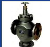
Регулятор прямого действия недистанционный РТП предназначен для систем автоматического регулирования температуры охлаждающей жидкости, смазочного масла двигателей внутреннего горения.
