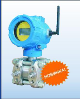
Серия микропроцессорных преобразователей давления **Аксон-100** осуществляет непрерывное преобразование значения измеряемого параметра: абсолютного давления, избыточного, разрежения, гидростатического и разности давлений нейтральных и агрессивных сред в цифровой сигнал, передаваемый по радиоканалу.
