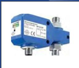
Датчики для наблюдения и контроля скорости движения жидкости, воздуха и газа на основе термодинамического принципа. Отсутствие механически-движущихся частей. Выход: аналоговый, цифровой и/или контакты реле.
