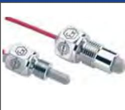
Фирма EGE Electronik производит широкий диапазон микроволновых, оптических и емкостных датчиков уровня жидкости и сыпучих веществ (порошков и грануляторов). Принцип действия: Если вещество касается острия датчика, на выходе датчика появляется сигнал оповещения.
