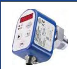
Малогабаритные датчики / реле давления для газов, паров и жидкостей с аналоговым выходом и устанавливаемыми границами срабатывания. Dn752 с 7-ми сегментным дисплеем для считывания показаний. Диапазон измерений: 0...1 и 0...16 бар.
