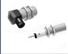
Индуктивные выключатели наиболее эффективно использовать в качестве конечных выключателей в автоматических линиях, станках и т.п., так как они срабатывают только на металлы и не чувствительны к остальным материалам.
