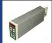
Регулятор ПРОТЕРМ 100 предназначен для применения в системах прецизионного регулирования температуры, в том числе программного, в электротермии, при производстве полупроводниковых материалов, опто волоконной техники, в процессе научных исследований и др.
