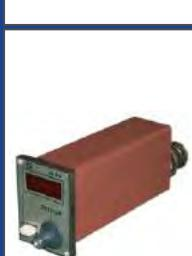
Задающее устройство ЗУ50 предназначено для применения в схемах автоматического регулирования различных технологических процессов в качестве выносного токового задатчика, как вспомогательного блока к регулирующим приборам, в том числе и микропроцессорным. Дистанционное введение информации о заданном значении регулируемой величины в виде изменения аналогового унифицированного сигнала постоянного тока. Цифровая индикация выходного сигнала постоянного тока.
