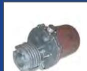
Фотодатчик пламени низкочастотный ФДЧ используется в топливосжигающих установках котлов и печей для контроля пламени. Преобразовывает низкочастотные пульсации видимого и инфракрасного излучения пламени в топочных камерах в электрический сигнал напряжения постоянного тока.
