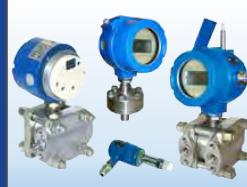
Предназначены для непрерывного преобразования значения измеряемого параметра: давления абсолютного (ДА), избыточного (ДИ), разрежения (ДВ), давления-разрежения (ДИВ), гидростатического (ДГ) и разности давлений (ДД) нейтральных и агрессивных сред в унифицированный токовый выходной сигнал.
