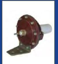
Тягомеры дифференциальные ДТ2 применяются в схемах автоматического регулирования в качестве первичных приборов, реагирующих на отклонение малых давлений, разрежений, разности давлений неагрессивных газов или воздуха от заданного значения и преобразующих это отклонение в электрический сигнал переменного тока. Предназначен для работы совместно с преобразователем типа П-ДТ.
