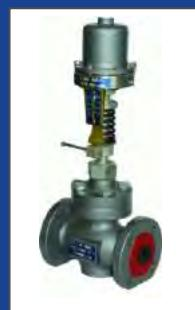
Регуляторы давления РДС-НО(НЗ) и регуляторы перепада давления РПДС, работающие без постороннего источника энергии, предназначены для автоматического поддержания заданного давления или перепада давления жидких, газо- и парообразных сред, неагрессивных к материалам регулятора.
