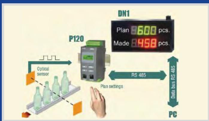
Подсчет и визуализация количества продукции на конвейерной ленте
