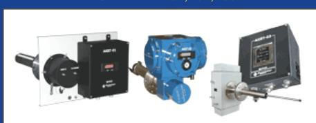
Предназначен для непрерывного автоматического измерения концентрации свободного кислорода и оксида углерода в отходящих газах процессов сгорания различных видов топлива с целью оптимизации режимов горения и выдачи унифицирован. сигнала.
