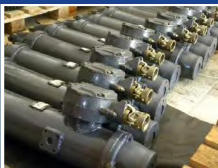
Привод винтовой моторный
