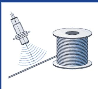
Контроль разрыва провода
