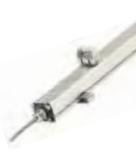
Имеют интегрированный аналоговый выход и могут подключаться непосредственно к системе управления или индикации, без какого либо интерфейса. Встроенная микроЭлектроника подготавливает выходное безступенчатое напряжение, которое является строго пропорциональным измеряемому пути. Уровень выходного напряжения устанавливается на изготовителе и при эксплуатации не требует калибровки.
