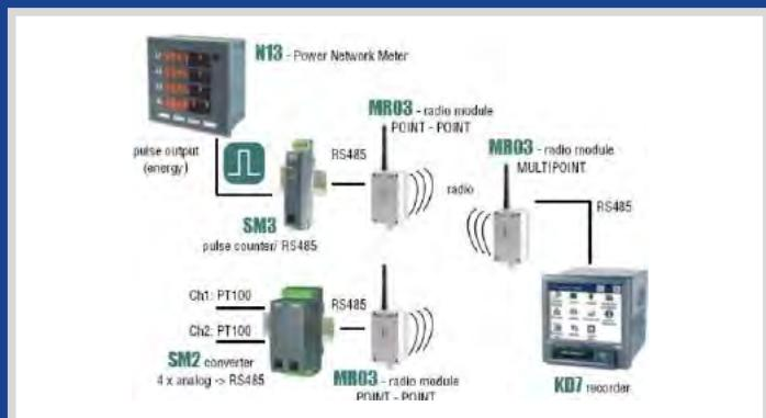
Система измерения температуры и энергии с регистрацией параметров, передача данных с помощью модулей радиосвязи
